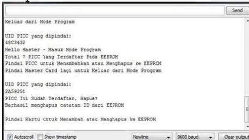
Dekatkan master card untuk keluar dari mode program tampilan serial monitor seperti digambar
