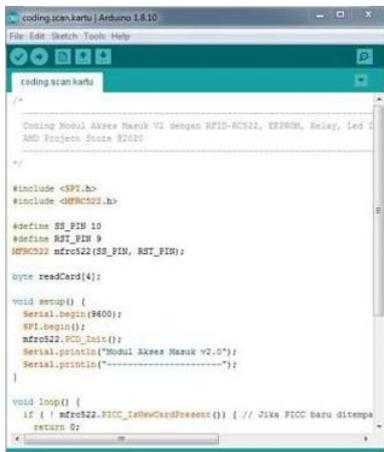
Sebelum melakukan up-loading pastikan arduino nano sudah terhubung dengan cara : klik tools >klik board > pilih Arduino nano > klik prosesor > pilih atmega 328 > klik Port > pilih COM yang terhubung dengan arduino nano. Jika sudah klik upload pada Arduino IDE seperti dibawah ini:
