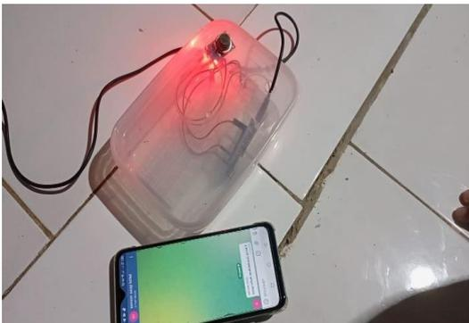
**Gambar 7. pengujian sensor asap**
