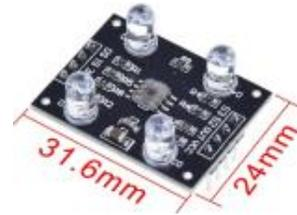
**GAMBAR 3.3** Sensor Warna TCS3200
