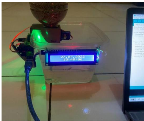
Gambar 5.1 Pengujian alat Pakan Ikan lele otomatis
