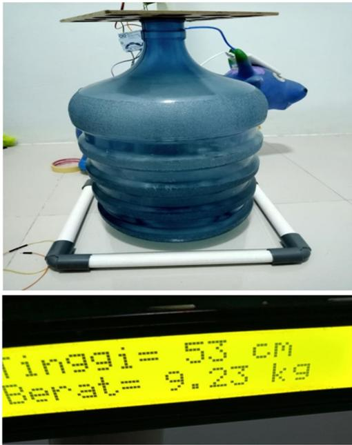
**Gambar 21. Hasil Pengukuran Alat Berbasis Arduino**
