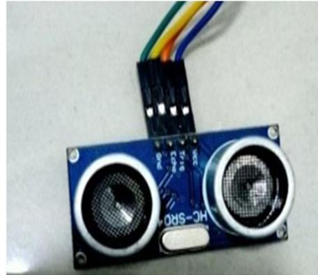
Gambar 14 Sensor Pengukur Tinggi Ultrasonic
