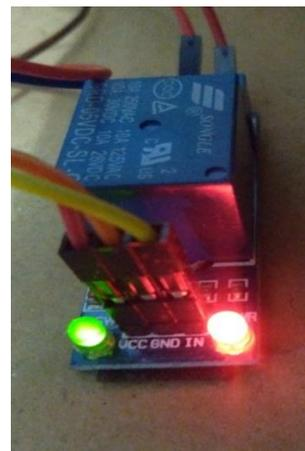
Gambar 18. LED warna hijau pada relay menyala (relay on) jika *password* benar
