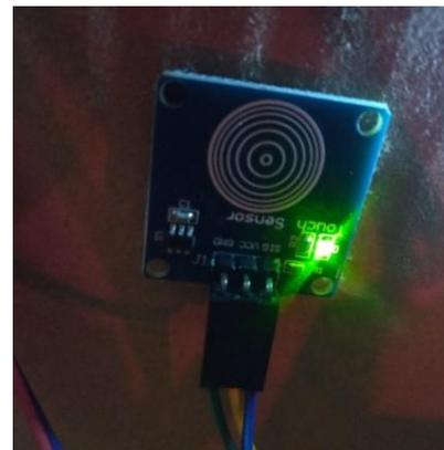
Gambar 2. Touch Sensor untuk membuka pintu dari dalam ruangan
