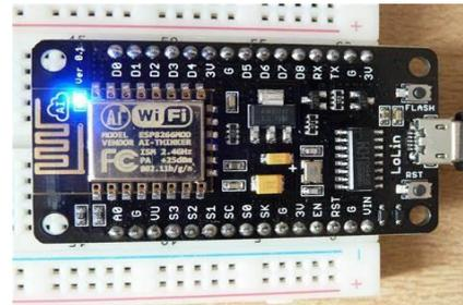
Gambar 5. Nodemcu 8266
