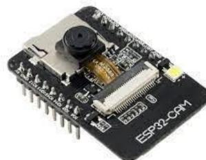
**Gambar 1. ESP CAM-32**
