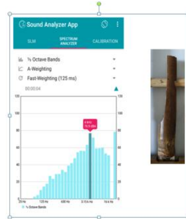
Gambar 6. Soundmeter analisis tabung diameter 1,5 cm tinggi 8 cm
